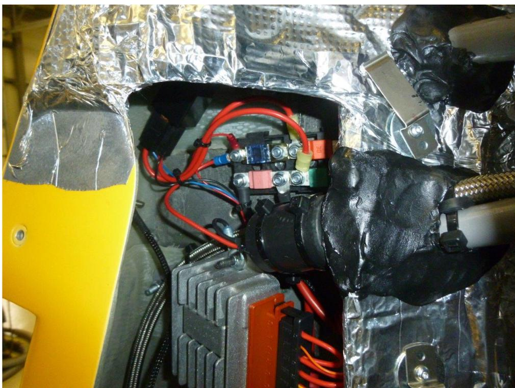
Рис. 3. Место расположения реле топливного насоса «Cavalon».
