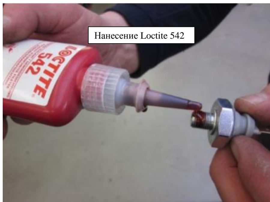
Рис.2 Нанесение герметика Loctite 542
