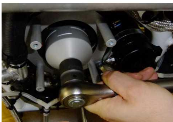
Рис. 5. Затяжка болта крепления 140Нм
