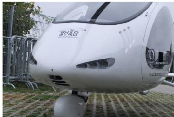
Воздухозаборник и прорези для конденсатора
