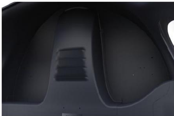
Воздуховод с воздуховыпускными отверстиями в кабине (за ними – испаритель)
