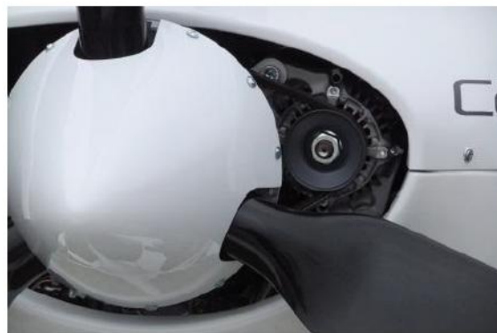
Приводимый от двигателя генератор переменного тока
